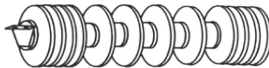
Fig. 11 Rubber Disk Return Idler
