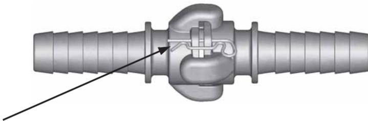
El uso del clip de seguridad para los cople "Air King", o el alambre utilizado, es necesario para asegurar que los cople no se desconecten accidentalmente. Esto garantiza que los conectores estén conectados correctamente ya que el clip de seguridad o el alambre no entraría en los hoyos de las bridas hasta que los cople estén en posición correcta. Solamente se necesita de un clip de seguridad o alambre por cada ensamble del cople Universal "Air King".
